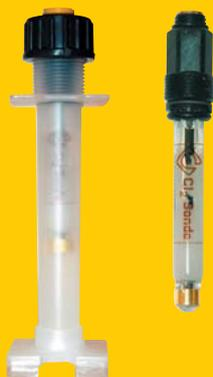
С помощью встроенного фильтра осаждаются даже мельчайшие загрязняющие частицы, при этом они не влияют на процесс измерения.
